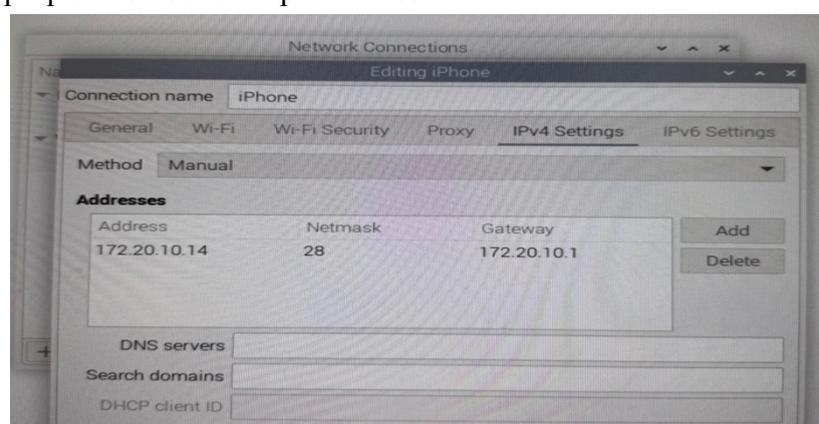
Cette configuration permet au Raspberry Pi de disposer d'une adresse réseau stable, facilitant la communication avec les autres équipements du réseau.
